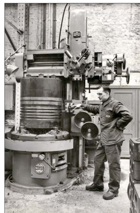
Machine destinée à l'usinage de pièces pour la réparation et la construction navales.
